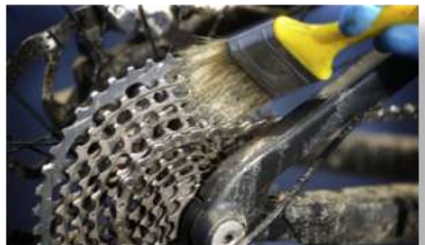
Sul pacco pignoni si può usare sempre il pennello oppure, rimuovendo la ruota posteriore, si può agire con una spazzola a setole dure. Risultato garantito.
